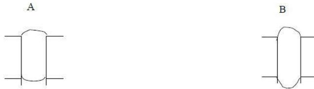
A: 压力和刮印速度较低情况的塞孔树脂在 PTH 孔中的横截面示意图
